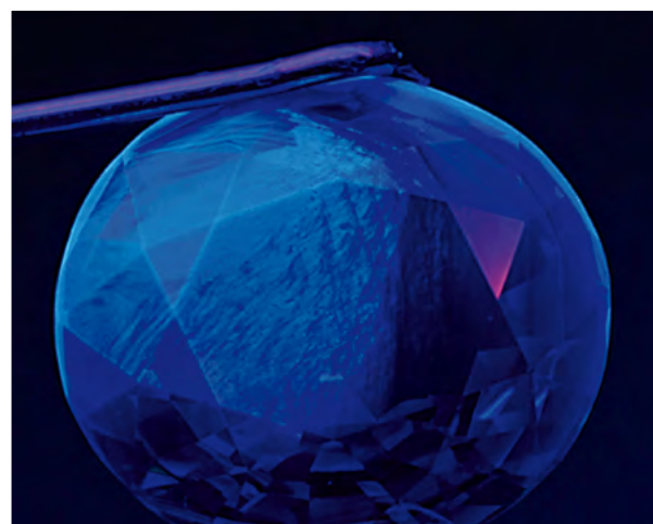
Fig. 1 Amore a ciuffi Quando si sottopone uno zaffiro ad un trattamento di riscaldamento ad alta temperatura spesso si viene a creare una fluorescenza UVC da un blu pallido ad un blu-verde. Come si può vedere sopra, questa reazione è confinata entro certe zone della gemma. Queste zone fluorescenti "a ciuffi" seguono la struttura cristallografica della gemma. Foto: Richard W. Hughes; Nikon D70
